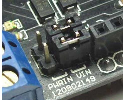
当 2 个短路帽插到左边时（PWRIN），就使用外接电源端口输入的电，如下图。
